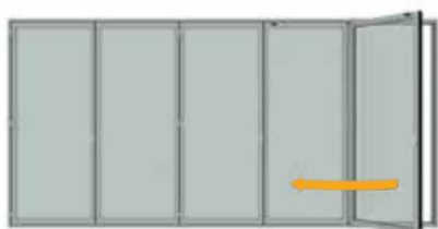
Leichtes Öffnen des äußeren Flügels Nem åbning af det første panel
